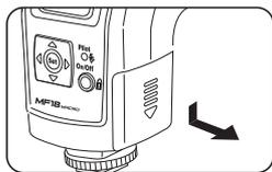
1. Sacar el compartimento de baterías e insertar 4 x AA baterías como muestra en la imagen.
