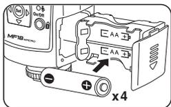
2. El compartimento de baterías está diseñado para que solo pueda entrar en una posición y evitar confusiones.
