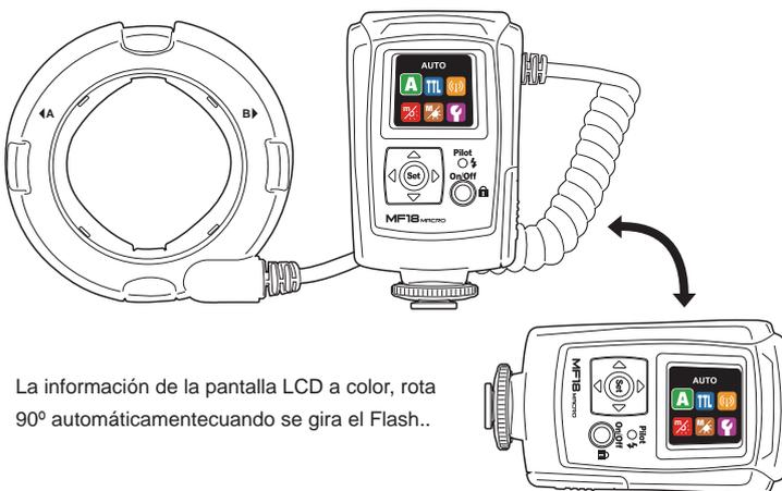
La información de la pantalla LCD a color, rota 90° automáticamente cuando se gira el Flash..
