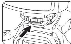
3. Deslice el flash MF18 hacia dentro de la zapata de flash de la cámara.
